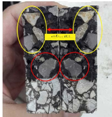
شکل ۹. انتشار ترک از طریق سنگدانه ها و قیر
