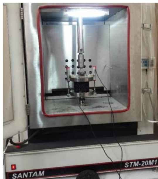
شکل ۳- تنظیم تست خزش استاتیک
