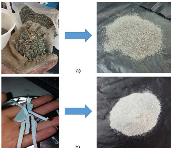
شکل ۲. (a) ذرات PVC روکش آب نبات، (b) لوله فاضلاب PVC
